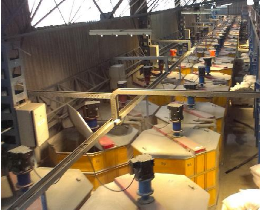
Resim 5: EMF Motor ile değiştirilmiş Glazur tankları (turuncu olanlar ilk takılan motorlar)
