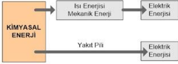
Şekil 6 Kimyasal enerjinin elektrik enerjisine değişik dönüşüm yolları [6]
