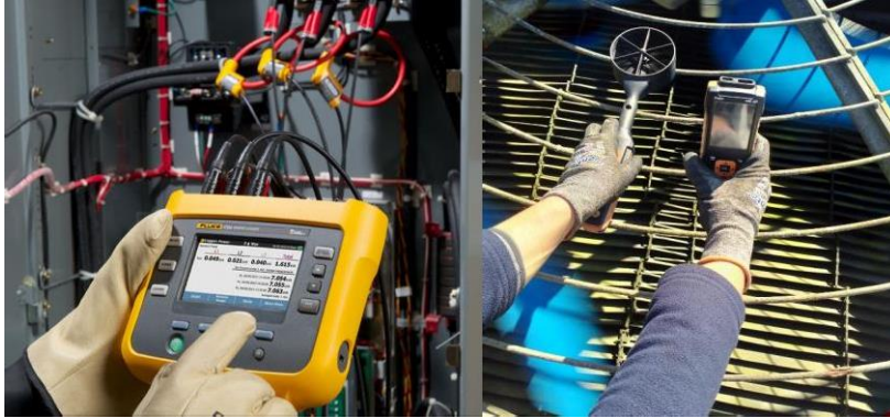
Şekil 3.1 Soğutma kulesi fanlarında aktif güç ve hava hızı ölçümü (URL-1)
