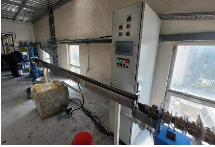
Şekil 8. Kompozit Filament Üretim Düzeneği
