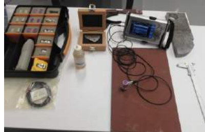
Şekil 3. Plakaların ultrasonik muayenesi
