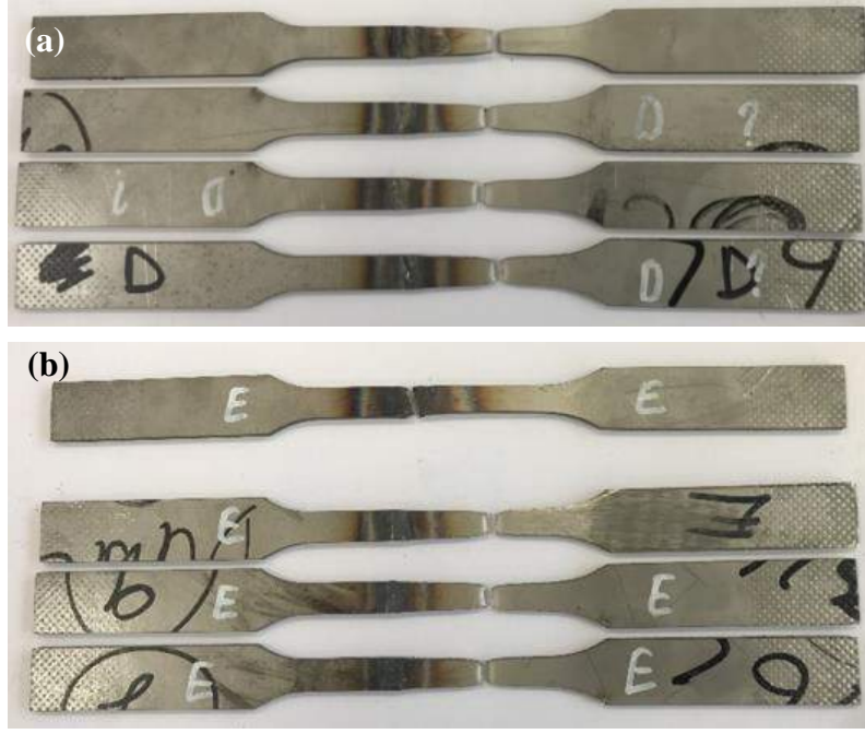
Şekil 8. Kaynaklı bağlantılardan çıkarılan kaynağa dik çekme deneyi numunelerinde kırılmanın kaynak dikişi dışında gerçekleştiğini gösteren makro resimler: (a) ER2209 ve (b) ER309L ilave tel ile elde edilen bağlantı numuneleri. (Not: ER309L ile elde edilen bağlantı numunelerinden biri kaynak dikişinden kopmuştur)
