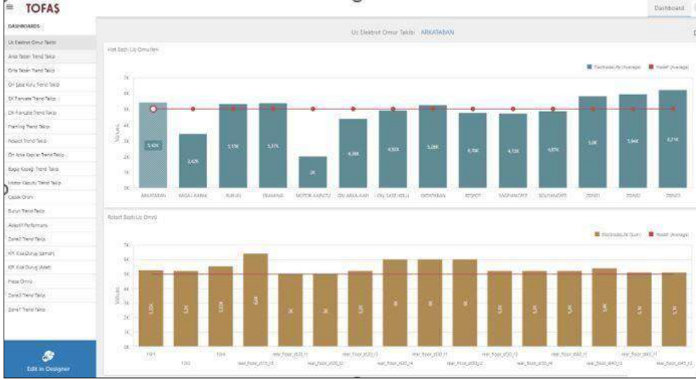
Şekil 11. Hat ve Robot Bazlı Uç Elektrod Ömür Takip Arayüzü
