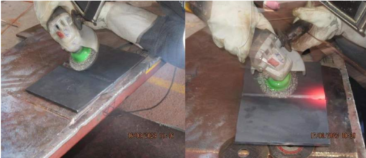
Resim 3 : Ön ısıtma sonrası oksit tabakanın temizliği
