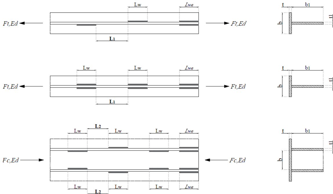
Şekil 5. Aralıklı (kesintili) köşe kaynak boşlukları ( L_1 , L_2 ); dizilimleri ve eksantrik yerleşimleri [5].
