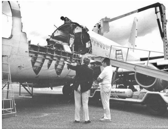
Şekil 1. Aloha Airlines 243'ün malzeme yorulmasına bağlı kazası sonrası fotoğrafı (1988).
