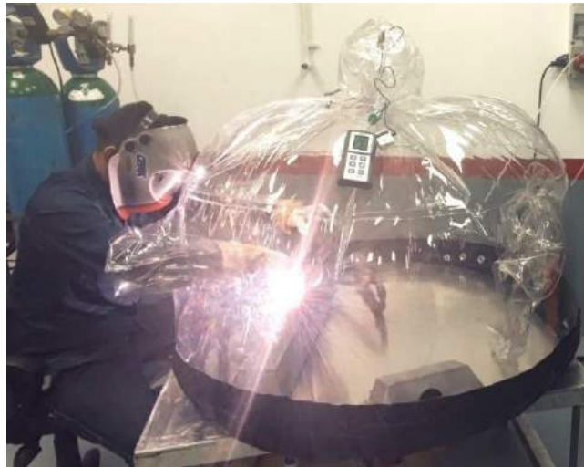
Resim1: Kapalı Koruyucu Gaz Ortamı
