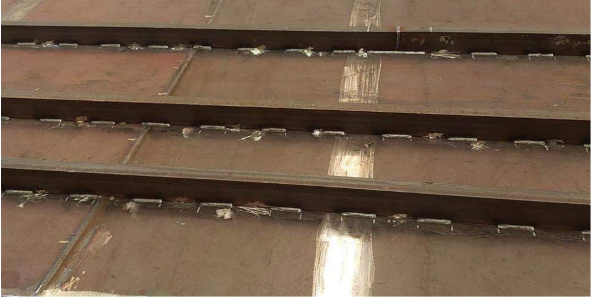
Şekil 6. Vinç köprü kirişi kaynaklı imalat prosesinde; taşıyıcı kiriş yan plakalarında metot köşe kaynağı (90°) uygulaması (BVS CRANES).
