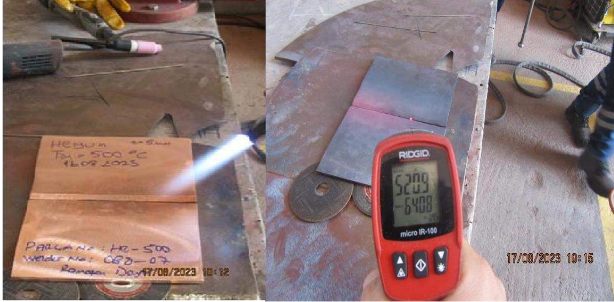
Resim 2 : Kaynak öncesi ve ön ısıtma esnasındaki uygulama
