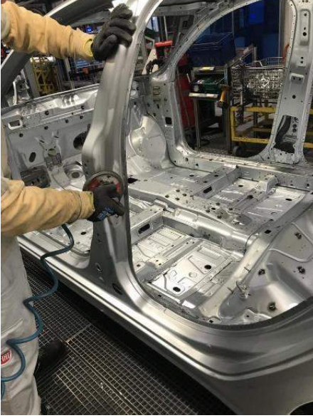
Şekil 2. Araç Kaportası Üzerinde Yapılan Manuel Revizyon Uygulaması
