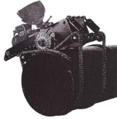
Şekil 1.2 Talaşlı imalat ile kaynak ağzlarının hazırlanması [2]
