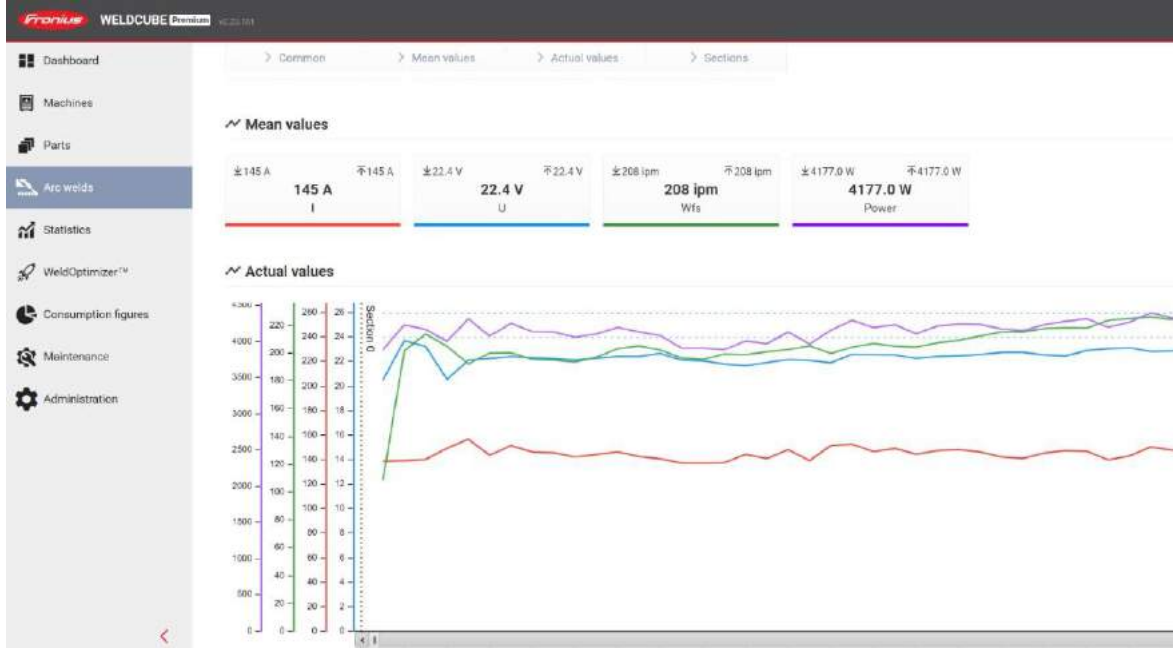
Şekil 5. Kaynak dikişlerinin tel, gaz ve tüketim verileri
