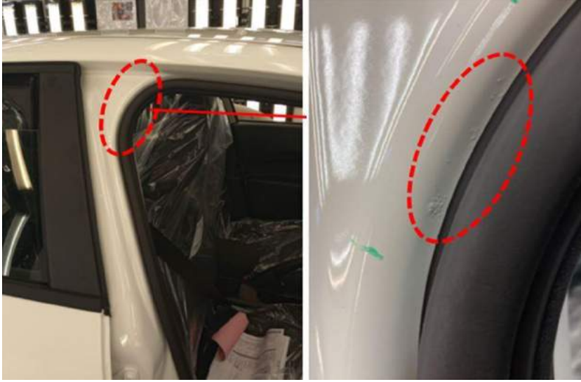
Şekil 1. Boyanmış Otomobil Üzerinde Tespit Edilen Kaynak Çapak Sıçrama Hatası (Estetik Hata Sınıfı)
