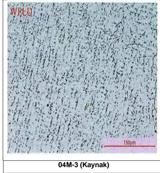
Şekil 3. SMO254 FCAW kaynaklı bağlantılar için mikroyapılar
