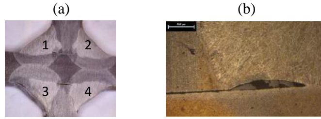
Şekil 6. CTKN 1 makro muayene görüntüsü (a), 2 numaralı kaynak yetersiz nüfuziyet görüntüsü (b),
